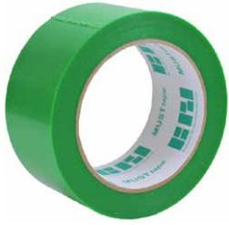
Bei diesem Mehrzweck-Klebeband wird ein spezielles Polyethylen-Gewebe als Trägermaterial verwendet, das eine ausgezeichnete Zug- und Reißfestigkeit aufweist und sich dennoch leicht von Hand ohne Cutter ablängen lässt. Für den Klebstoff wird Acrylharz verwendet, wodurch einerseits die Klebekraft stark genug ist, um fest angebracht zu werden, aber andererseits keine Kleberückstände entstehen. (Hat einen hausinternen Kleberückstandstest für 6 Wochen im Innen- und Außenbereich bestanden)
